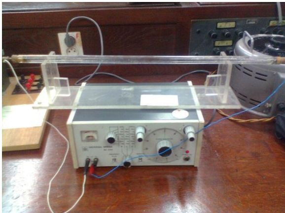
Slika 4. Uređaj za merenje specifične električne otpornosti vode
