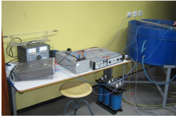
Slika 2. Uređaj za merenje raspodele potencijala na zadatom pravcu
