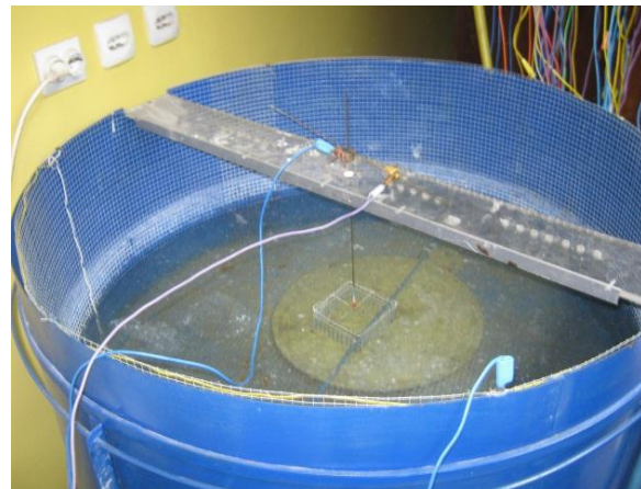
Slika 7. Merenje raspodele potencijala
