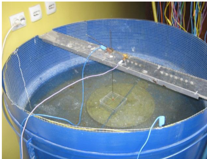
Slika 1. Umanjen model uzemljivača u kadi
