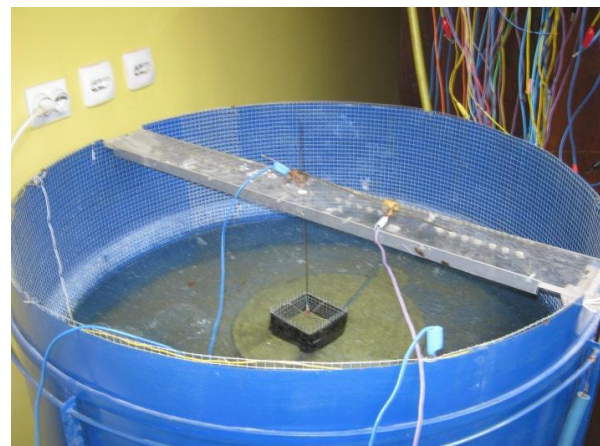
Slika 9. Merenje raspodele potencijala za uzemljivač sa izolacijom
